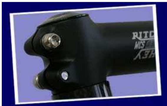
La chiusura posteriore blocca l'attacco sul tubo forcella. Nella soluzione proposta dalla Ritchey le viti sono incrociate per migliorare l'uniformità della chiusura.
